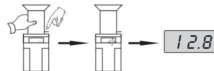
5. 关上落料筒的料门，倒出传感器内的样品，准备下一次的测量。
