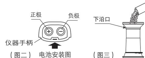
4. 将落料筒放于仪器传感器上，左手扶住落料筒，右手轻按落料开关，使样品全部均匀落入测量传感器，小数点闪烁数次后显示水分值（无需按任何键，落料筒也不必拿开）；
