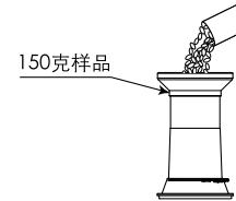
4. 将落料筒放于仪器传感器上，左手扶住落料筒，右手轻按落料开关，使样品全部均匀落入测量传感器，小数点闪动数次后显示水分值；
